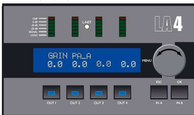
Рисунок 13: Установка усиления канала OUT 3
