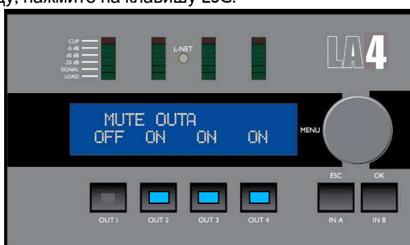
Рисунок 12: Выход 1 включен, выходы 2-4 выключены
