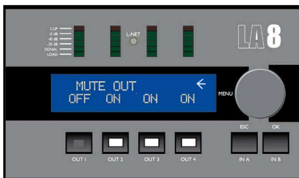
Рисунок 18. Выход 1 включен, выходы 2 – 4 выключены
