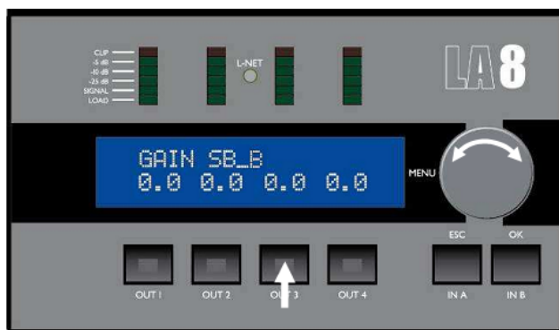
Рисунок 19. Настройка усиления выходного канала OUT 3
