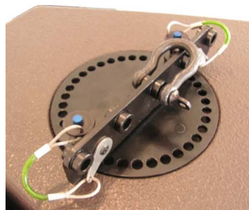
(4) Две фиксирующие шпильки крепят XTЛIFTBAR. Позиции чекеля (от передней к задней) дают углы наклона: +18^\circ , +11^\circ , +3^\circ , -5^\circ , -13^\circ
