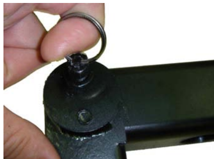
(2) Ослабьте фиксатор поворотного плеча
