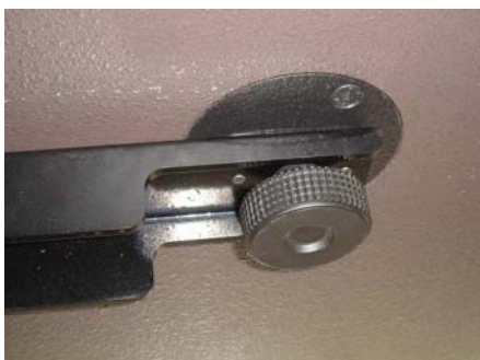
(7) Поверните SB15P на требуемый угол и затяните ручку настройки угла (фиксирующая шпилька поворотного плеча защелкнется автоматически, когда ручка будет достаточно затянута)
