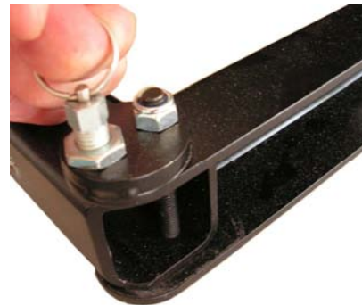
(4) Ослабьте фиксатор поворотного плеча
